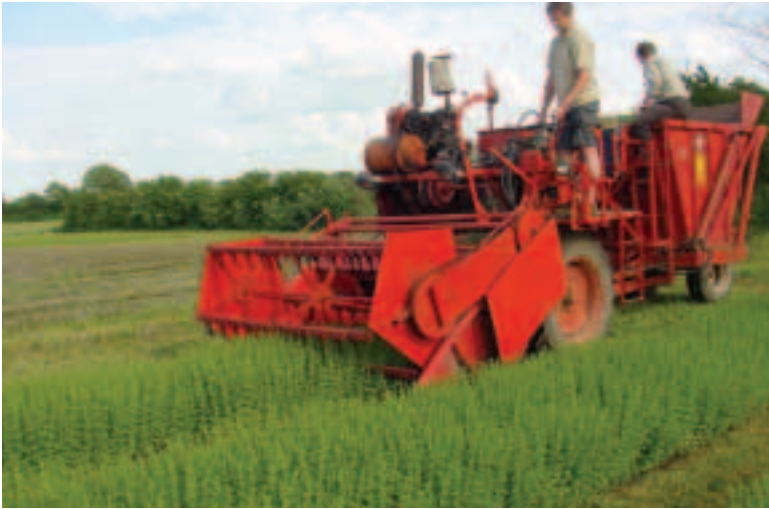
Foto 4. Høst af oregano med en ombygget mejetærsker (Foto Søs Kylling)
