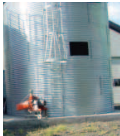
Foto 7. Plantematerialet fra høst af oregano kan tørres i et silotørreri som vist her på billedet. Gulvet i siloen er en perforeret plade, hvor der blæses passende varm og tør luft igennem. Det er nødvendigt at 'omrøre' i den friske plantemasse for at undgå at der udvikles varme (Foto Søs Kylling).
